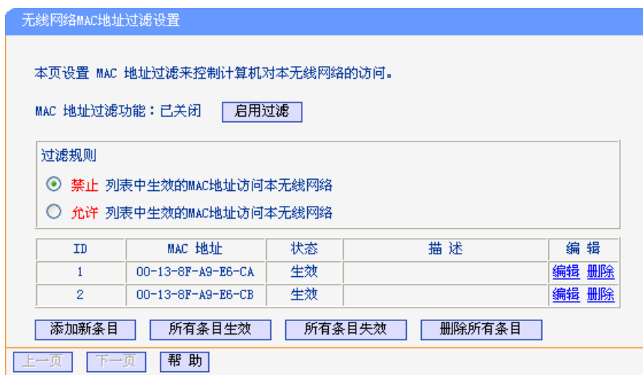
图 5-17 无线网络 MAC 地址过滤设置
