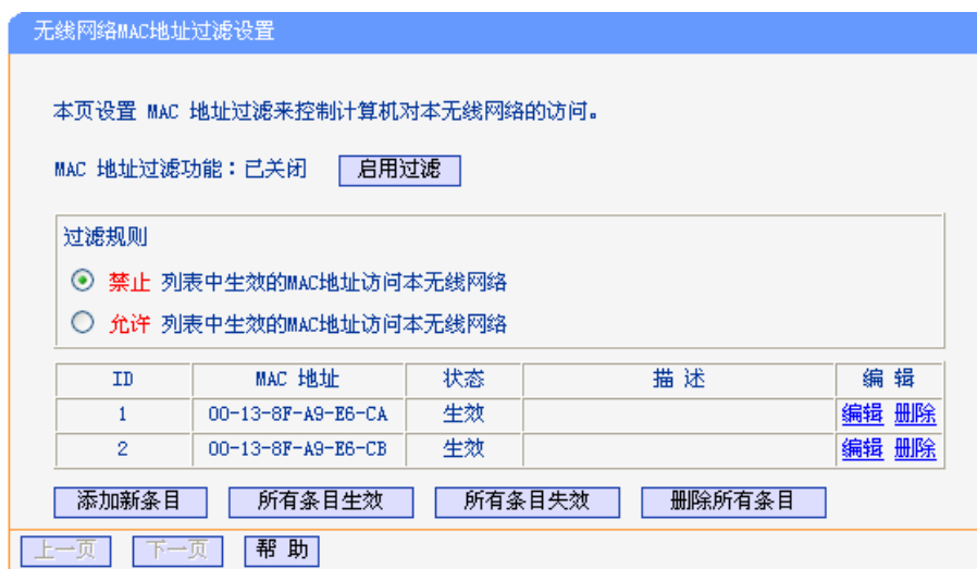
图 5-30 无线网络 MAC 地址过滤设置
