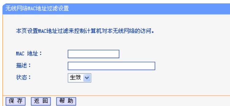
图 5-31 无线网络 MAC 地址过滤设置
